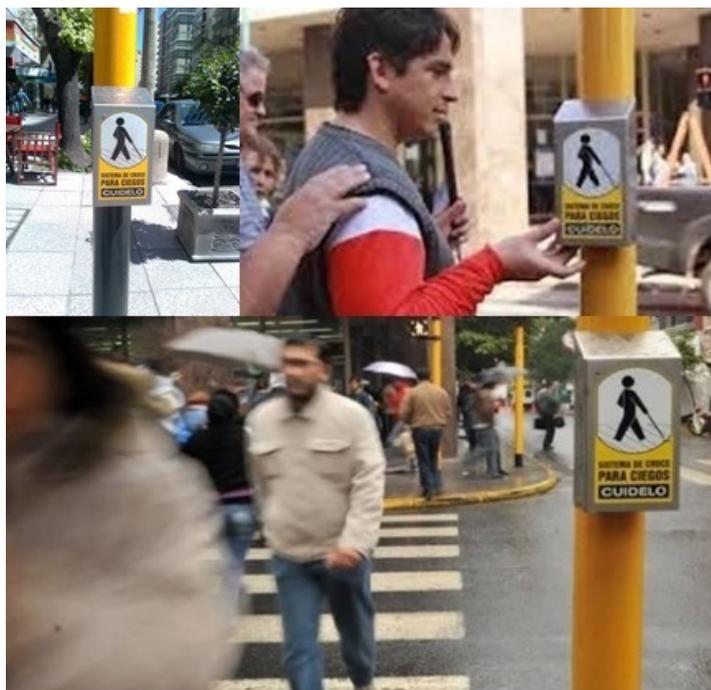
Los módulos SPC-800 emiten un sonido bitonal sincrónico de bajo volumen en todas las unidades que servirá de guía al invidente para ubicar la unidad correspondiente al cruce que pretende utilizar. El volumen del sonido se ajusta automáticamente el ruido del medio ambiente. Cuando el invidente ubica el Módulo SPC-800 y pulsa la demanda, la unidad emite un beep de confirmación que valida la aceptación de la demanda.
